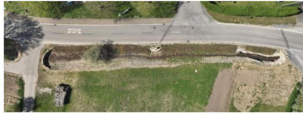
Bereits im vergangenen Jahr hat das Tiefbauamt den **ehemaligen, sogenannten „Feuersee“ aus dem Gewässerquerschnitt des Brunnenwiesebachs in Dahenfeld** zurückgebaut. Das schmale Betonbecken diente ursprünglich als Löschwasserreservoir. **Der Gewässerabschnitt entlang der Bismarckstraße wurde durch die Hinzunahme des rechtsseitig begleitenden Feldwegs deutlich verbreitert und naturnah gestaltet.** Im November erfolgte die Böschungssicherung durch eine naturnahe Bauweise.
